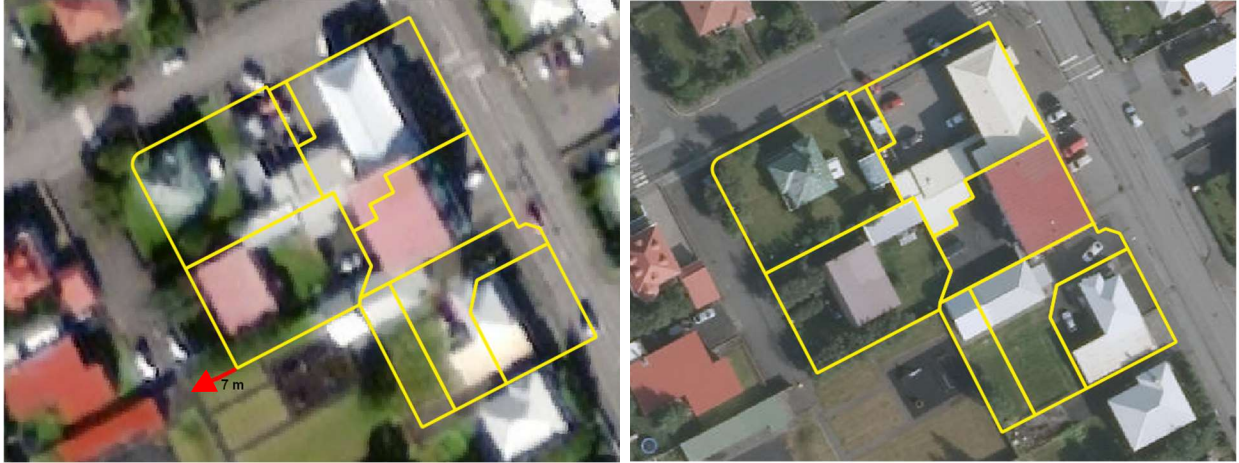
Mynd 2 Tvær myndir af ólíkum uppruna sem sýna byggð og eignamörk í Reykjavík. Myndin til vinstri er óupprétt gervitunglamiynd frá Maxar sem LMÍ keypti nýverið með um 50 cm upplausn. Skekkja frá mældum hnitum eignamarka í landeignaskrá (gular línur) er um 7 metrar. Myndin til hægri er upprétt loftmynd frá Samsýn ehf. frá árinu 2014 með um 25 cm upplausn og samsvarandi mikilli staðarnákvæmni þannig að eignamörk falla saman að legu lóðanna á myndinni.
