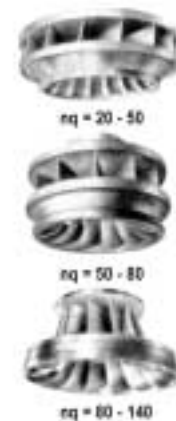
Mynd 6.7 Mismunandi gerðir vatnshjóla fyrir Francis hverfla eftir fallhæð. 13 N_q er eðlishraði hverfils, sjá kafla 6.2
