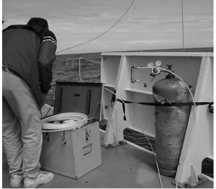
MYND 2 Gashylki fyllt með ^3\text{He}/\text{SF}_6 tengt við slöngu til dælingar.
